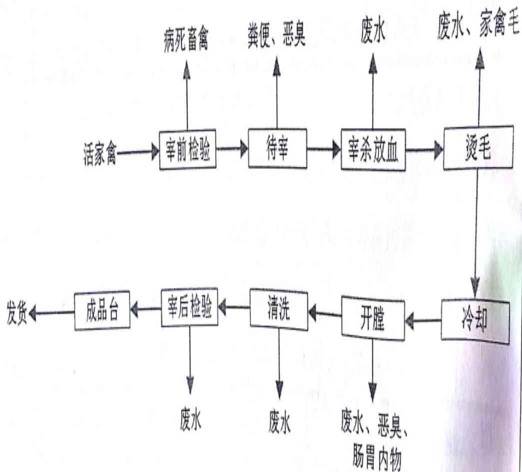
图 5-1 项目生产工艺流程及产污位置图
