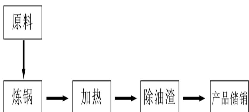
图 1 生产工艺流程图
